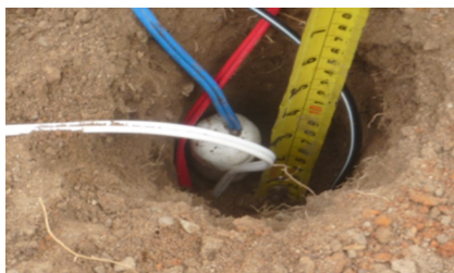
Picha 3. Picha hapo chini ikionyesha usimikaji wa kifaa cha kupimia unyevu ardhini
