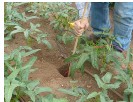
Picha 4. Picha hapo chini ikionyesha ufukiaji wa shimo lenye kifaa cha kupimia unyevu
