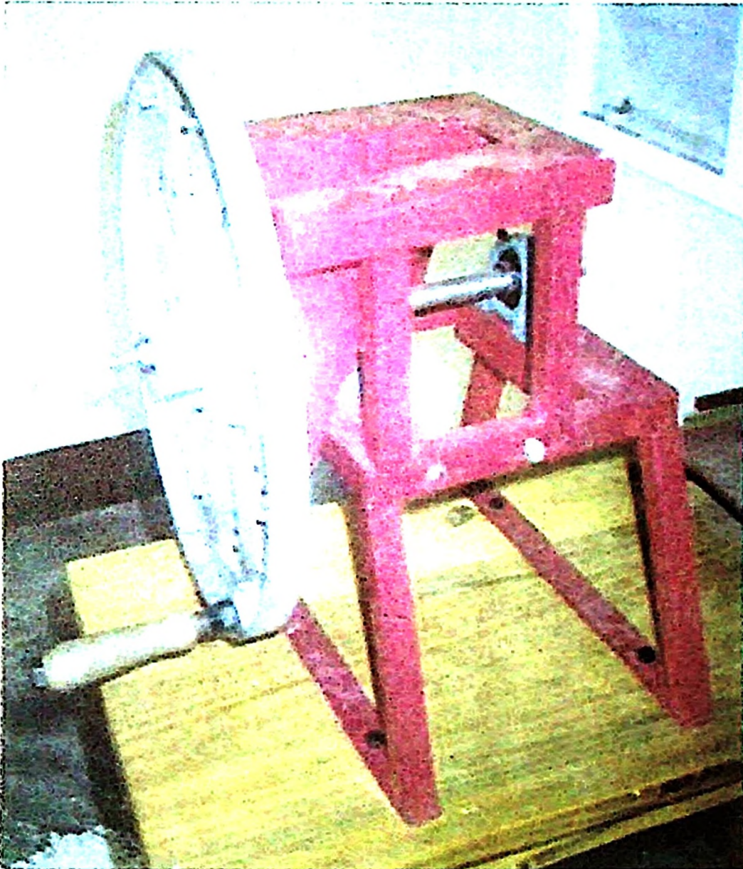
Picha na.1. Mashine ya kukata chips za muhogo ya kufunga kwenye meza (Uwezo:kilo 50-80 kwa saa)
