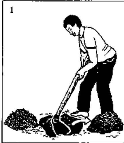
Shimo huchimbwa kwa kutofautisha tabaka za udongo. Udongo wajuu huchimbwa ukawekwa upande.
