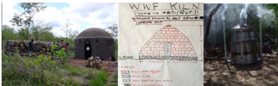
Picha Na. 12: Matanuru ya kisasa ya kuchomea mkaa aina ya Nusu chungwa (Half orange) na muundo wa pipa (steel ring drum) yaliyojengwa kwa matofali ya udongo—
