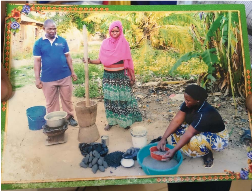
Picha Na.18: Mkaa laini uliotengenezwa kwa kutumia magugu ya shambani unapondwa kwa kutumia kinu na mchi asilia na kuchanganywa kwenye uji wa mhogo kisha kuwa mkaa mbadala wenye umbo la mpira kuumbwa kwa mikono na Familia ya Bardwin F. Mpunga nchini Tanzania.
