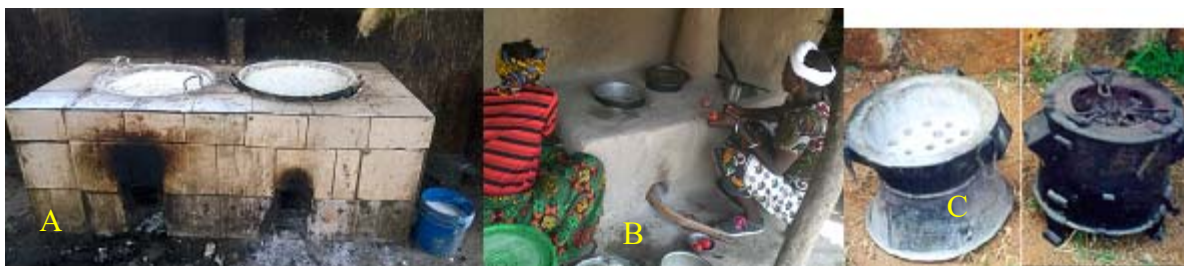
Picha Na. 13: Majiko ya kisasa ya kuni yanayotumika kwenye taasisi (a), matumizi ya nyumbani (b) na jiko la kisasa la mkaa (c)
